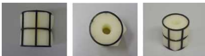
写真 1 アグラ DHS リアクターに投入した担体 (G3.4) の外観
