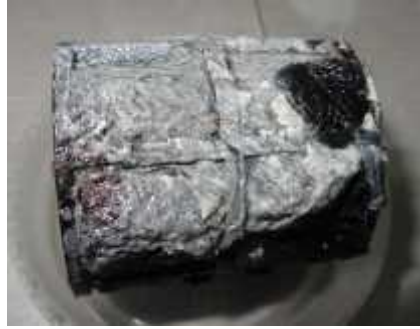
写真8 アグラ DHS リアクターにおいて過剰に肥大化した汚泥の様子
