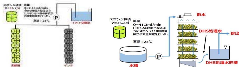
図 10 トレーサー実験装置 左：懸垂型 右：充填型
