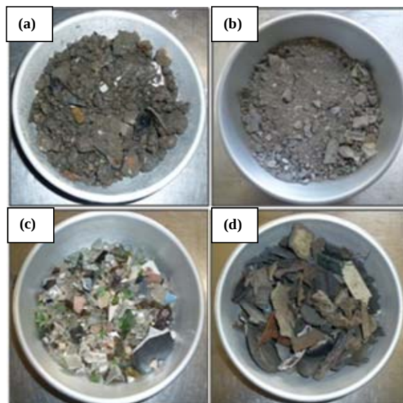
図6 室内実験で用いた廃棄物試料 (a)埋設産業廃棄物、(b)焼却灰 (c)不燃廃棄物(一般)、(d)産業廃棄物(プラ主体)
