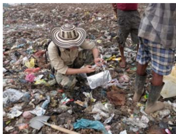
図4 廃棄物処分場における埋設ガスサンプリング
