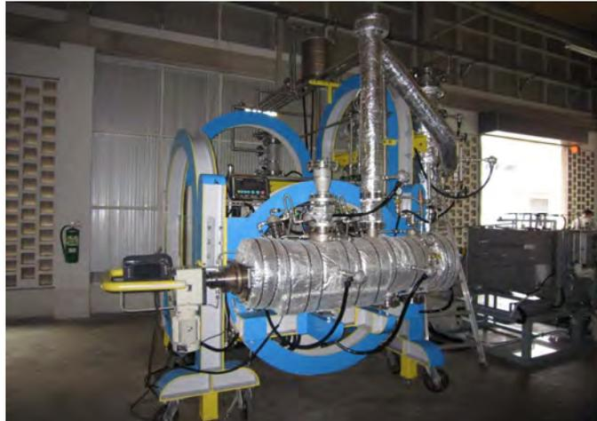
内部攪拌式、原料供給速度 10 L/h、反応器容量 30 L
