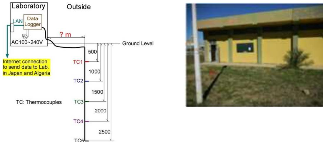
図3 熱電対による地中温度の測定の状況と実験室及び設置場所。右図は、**建家と測定点（赤丸）**
