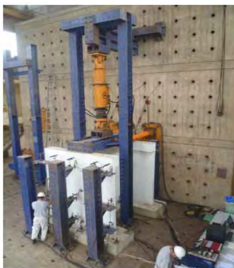
図 4.3.3 CISMID に油圧式加力システムを導入し、低靱性 RC 壁、枠組み組積造をはじめペルーに特有の構造部材の破壊実験を数多く実施し、その破壊性状を明らかにした。
