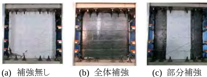
図 4.3.5 炭素繊維シートを用いた補強実験から、壁の両脇に貼り付けた安価な部分補強でも十分に脆性破壊を防止できることを明らかにした。
