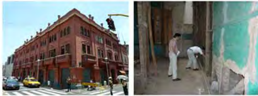
図 4.3.6 リマ旧市街地の歴史的アドベ造建物の微動計測
