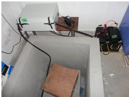
設置された速度型強震計と NGRI でのデータ検討
