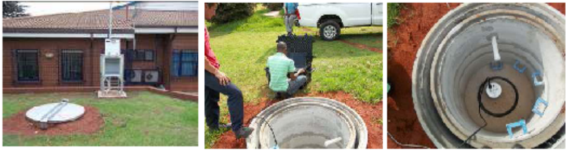
写真3 各観測点(図7参照)では、岩盤に達するまで、あるいは、最低2mの表土が取り除かれ地震計が設置された。データはGPRS無線電話通信によってプレトリアのCouncil for Geoscienceまで転送されている。
