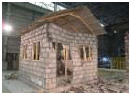
写真左：No. 10 加振後状況（東南方向よりモデル B）面外壁の大きな損傷および崩落。 写真右：No. 12 加振後状況（東南方向より）モデル B 全壊、モデル A は面外崩壊、面内にせん断クラック発生するものの崩壊せず。
