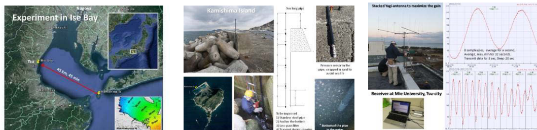
三重県神島に設置された無線潮位計と三重大工学部の受信装置および潮位記録
