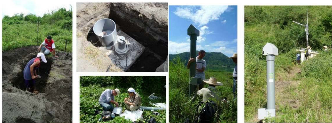
オーバーハウザー全磁力測定装置の設置
