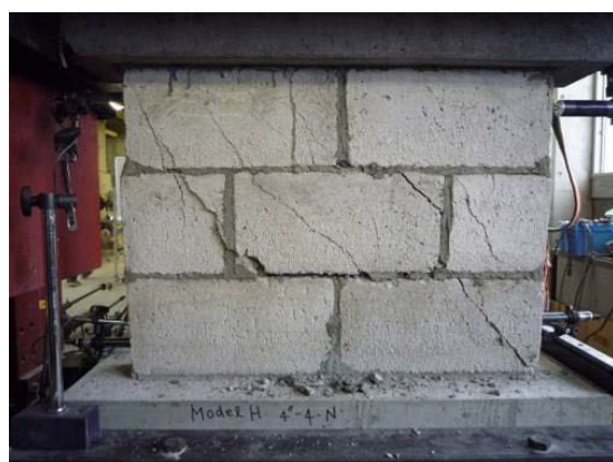
フィリピン型コンクリートブロック (CHB) 組積造せん断力実験
