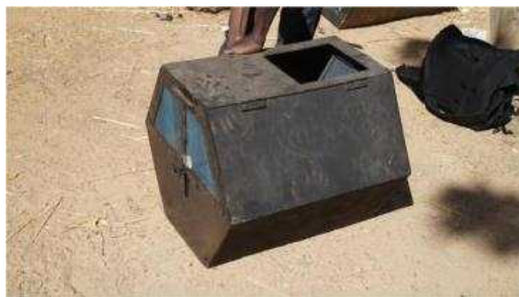
図-4. 2. 6 (a) 現地で製作したFRP製反応槽
