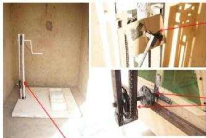
図-4. 2. 4 チェーンを用いたハンドル型攪拌装置
