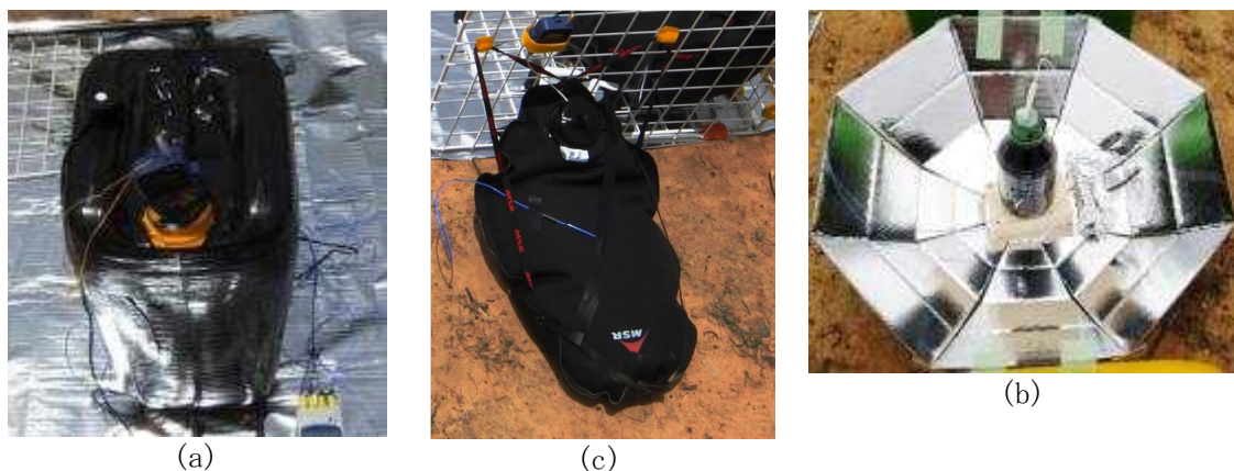
図-4.5.5 太陽熱による加熱実験 (a)ポリタンク, (b)ドロメタリーバッグ, (c)Duran 瓶
