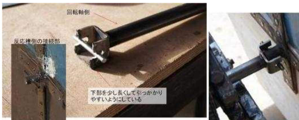
図ー4. 2. 6 (c) 反応槽取り付けのためのユニバーサルジョイント(日本製)
