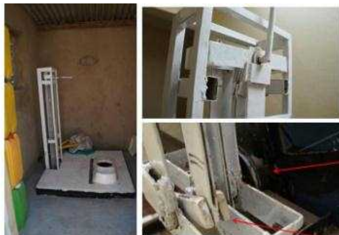
図-4. 2. 3 リンク機構を用いたハンドル型攪拌装置
