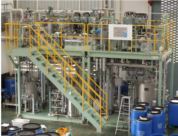
図 2 タイ洪水被害後に補修され 運転性能が回復した高品質 BDF 製造パイロットプラント（1.0ton/ 日、タイ科学技術研究院内設置）
