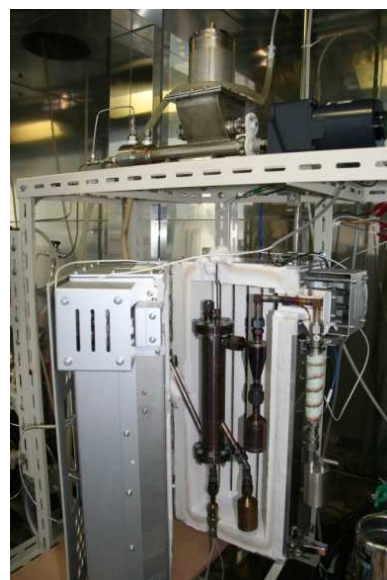
図 12 流動層熱分解炉本体部（～30g バイオマス/h）
