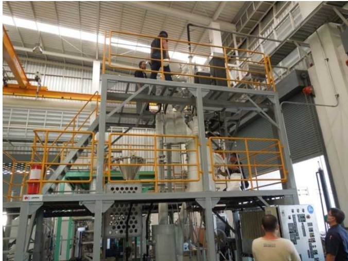
図 13 タイ科学技術 研究院内に設置され たバイオオイル製造 用 循環流動層型熱 分解パイロットプラ ント
