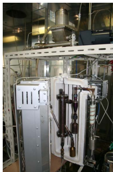
図 9 流動層熱分解炉本体部 (～30g バイオマス/h)
