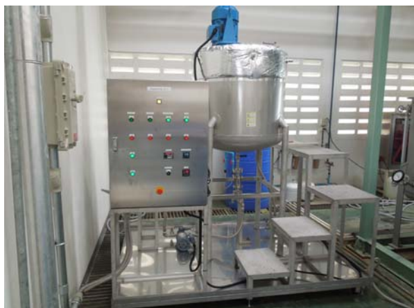
図 4 タイ科学技術研究院内に設置された脱ガム試験装置
