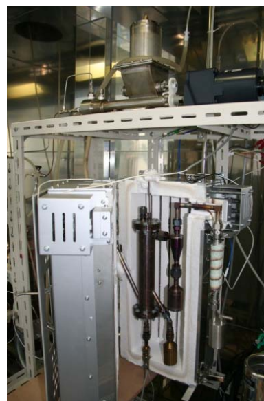
図5 流動層熱分解炉本体部 (～30g バイオマス/h)
