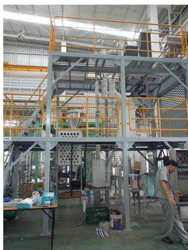
図 27 タイ科学技術研究院内に設置されたバイオオイル製造用循環流動層型熱分解炉パイロットプラント(約 20kg/h 規模)
