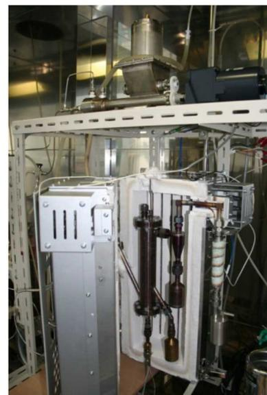
当該熱分解装置では、バイオオイル蒸気の回収が十分でなかったが、バイオオイル凝縮部に電気集塵器を自製し、導入することにより回収率を大幅に向上できた (図 24)。従来使用していた冷却もしくは溶媒によるバイオオイルの凝縮に比べ、大幅に液収率が向上することを見出した (ジャトロファケーキ使用時: 約 50%、スギ粉使用時、約 65%)。
