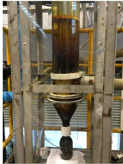
図 29 改良型電気集塵機によるバイオオイルの回収
