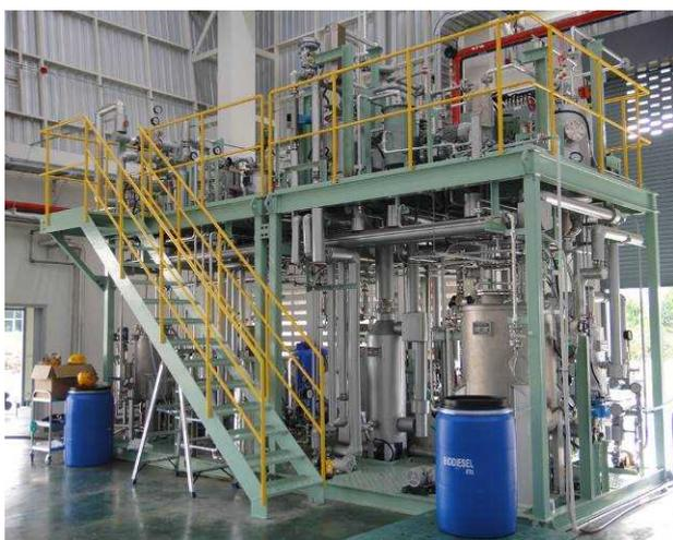
図2 タイ科学技術研究院に設置された高品質 BDF 製造パイロットプラント (1.0ton/日)
