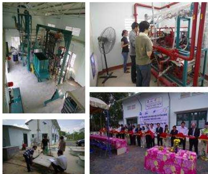
図 4.1.20 Thai My デモンストレーションプラント(左上:炭化/発電複合プロセス、右上:発電機室、左下:埋設式メタン発酵槽、右下:開所式の様子)
