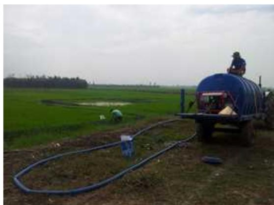
図 4.1.24 試作したトレーラータンクによる消化液の輸送・施用
