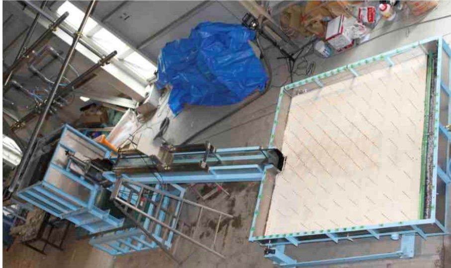
図 5 土石流実験用急勾配水路
