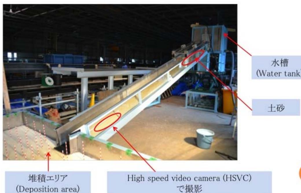
図8 急勾配実験水路
