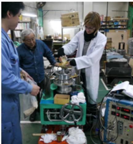
図 2 試作試験中のポータブル非排水リングせん断試験 (JICA-JST 報告会資料より)
