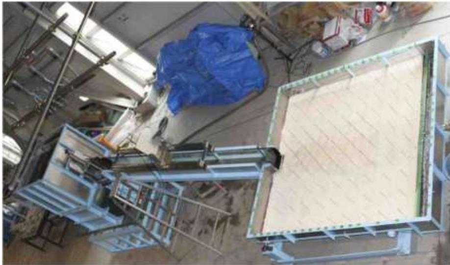
図8 土石流実験用急勾配水路
