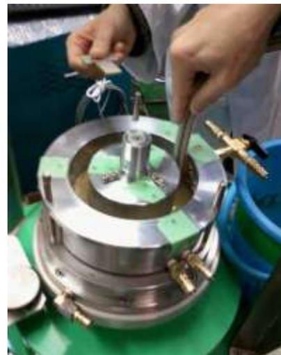
図3 ポータブル非排水リングせん断試験機用非排水せん断試料容器の構造
