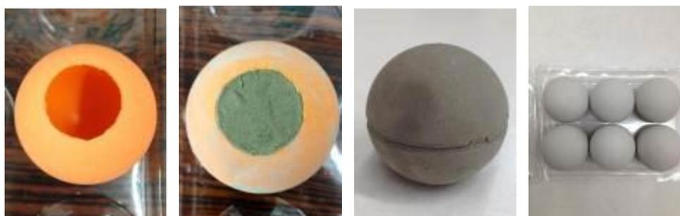
図 16 鉄化合物を含有するバイオフェントン反応用球粒子（左から型枠、鉄粒子およびコンクリート打込み、フェントンボール(拡大)、フェントンボール)
