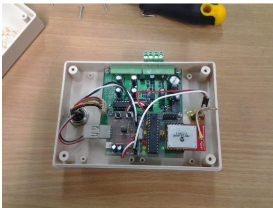
写真4 (左)開発した無線を利用したテレメトリシステムと(右)開発した斜面崩壊モニタリングシステム。
