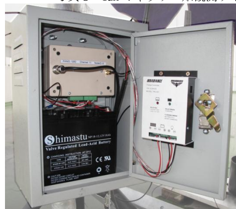
写真4 (左)開発した無線を利用したテレメトリシステムと(右)開発した斜面崩壊モニタリングシステム。
