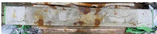
図 7 鉄筋腐食促進実験後の試験体の様子
