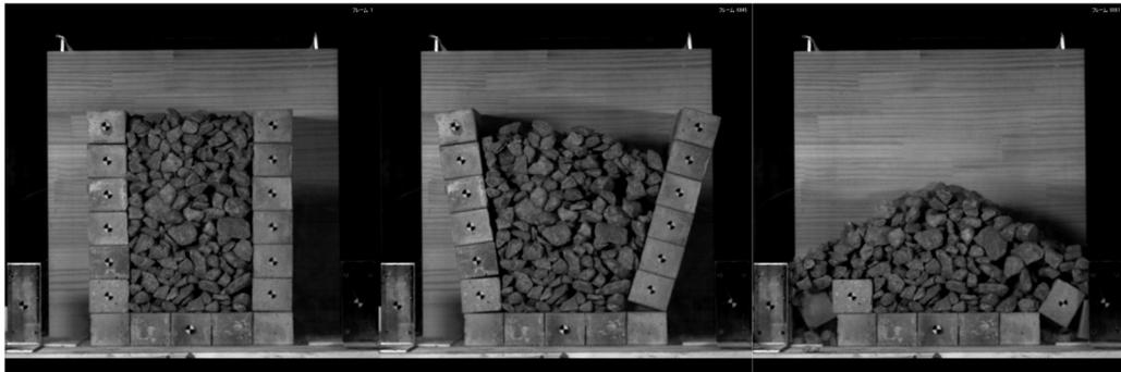
(a) 中詰め材が小さいとき (160gal で崩壊、8Hz 加振)
