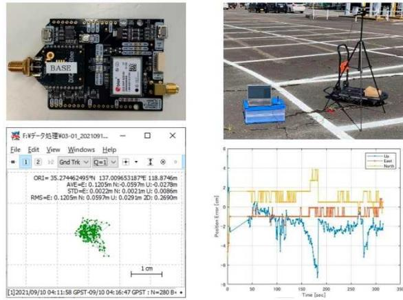
図 2-3-8 左上は使用した基盤、右上は実験風景、左下が後処理測位結果、右下がリアルタイム測位結果
