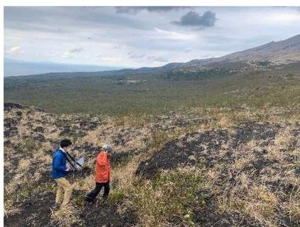
図 2-4-4-2 三宅島七島展望台付近における Livox Avia を用いた溶岩流地形の計測
