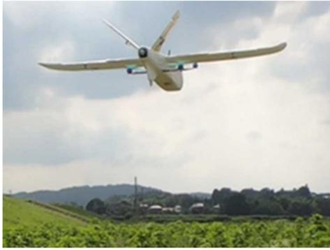
図 2-2-1-1 VTOL(垂直離着陸)固定翼機
