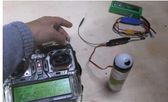
図 2-2-6-2 試作噴煙サンプラーの動作テスト
