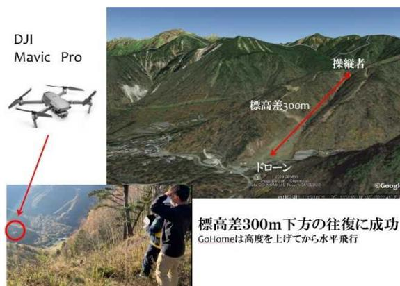
図 2-2-9-2 平湯温泉スキー場での下降飛行実験
