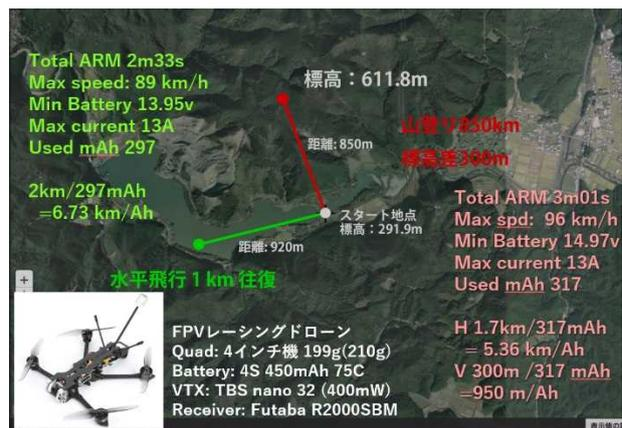
図 2-2-7-2 FPV ドローン登下降飛行試験 (Google Earth 画像に加筆)
