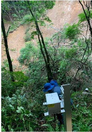
図 2-4-4-4 ヒル谷の崩壊斜面の LiDAR 計測
