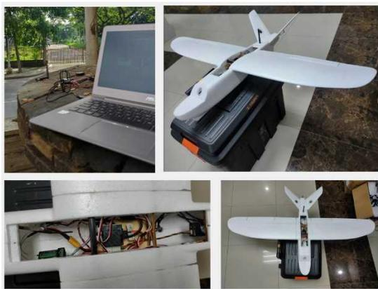
図 2-2-12-3 PHIVOLCS で組み立てられた固定翼 UAV 組立マニュアル
