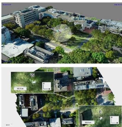
図 2-3-9 中部大学における写真測量実験により作成した高密度点群 (上) とオルソ写真地図 (下) 拡大してあるのは比較のための検証点
