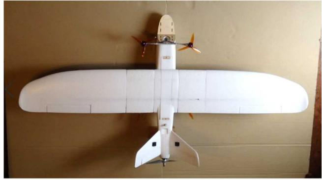
図 2-2-1-2 VTOL 機の主翼延長型
