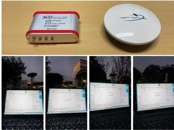
図 2-3-7 上段：PPP 受信機とアンテナ、下段：PPP による移動体精密測位
