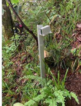
図 2-4-4-5 ヒル谷崩壊斜面对岸に設置した Livox Mid-70
