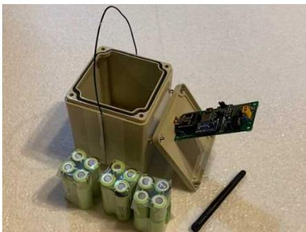
図 2-4-1-5 静置式無線地震計の防水容器および内蔵バッテリー
