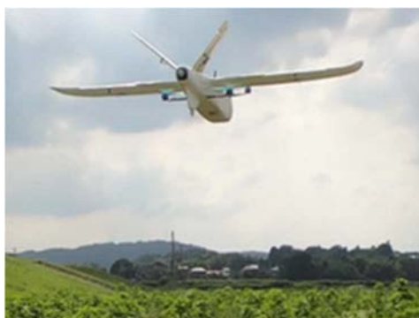
図 2-2-1-1 VTOL(垂直離着陸)固定翼機
