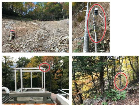
図 2-3-3 焼岳山麓ヒル谷の観測点 左上がヒル谷の地すべり地形 右上が設置した観測点 左下が京大観測所に設置した基準点、右下は中継点
