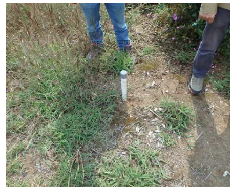
図5 Patuha 地区におけるラドン濃度測定結果。(左) 17 箇所の計測井でのラドン濃度分布 (2020 年 9 月) と (右) 代表的な 2 測点でのラドン濃度の時間変化パターン。右の写真は表層ボーリングによるラドン濃度測定用の計測孔の例を表す。
