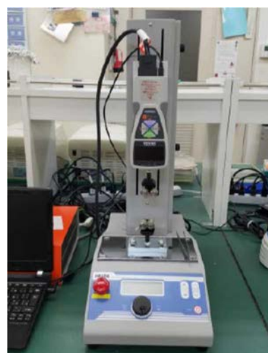
図 5 引張試験機によるゴムシート分解の評価
