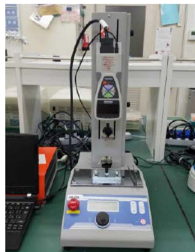
図4 引張試験機によるゴムシート分解の評価
