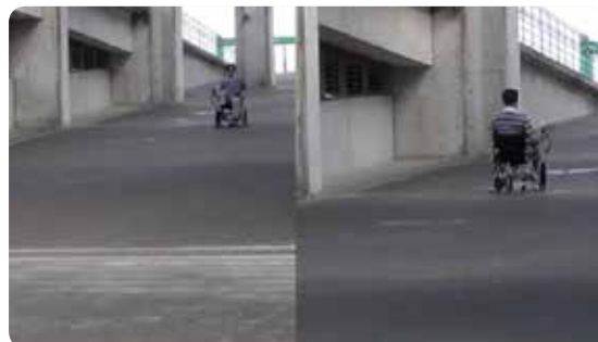
足こぎ車いすの屋外走行試験（最大傾斜7度）
