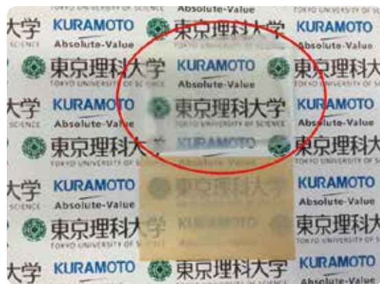
熱プレスで膜の均一化と透明化に成功した有機圧電PVDF（ポリフッ化ビニリデン）フィルム
