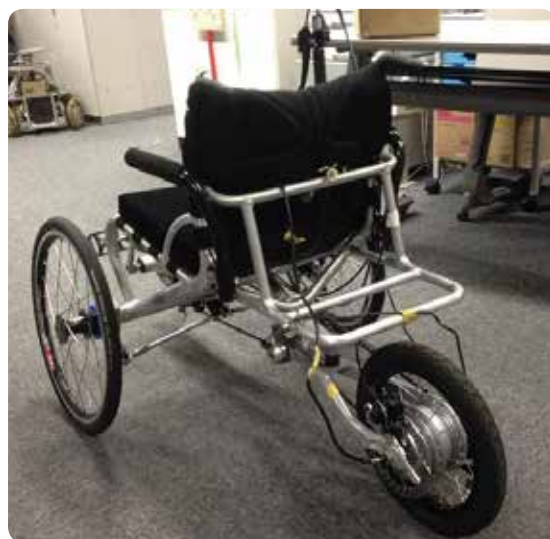
足こぎ車椅子試作機（CVT+制動制御機能付き）
