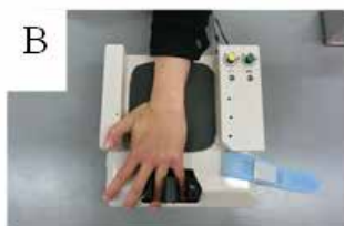
試作機のコンディショニング（示指、中指、環指、小指の内外転運動）動作の様子
