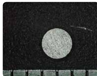
動物実験用試験片（2mmφ×0.5mmT）
