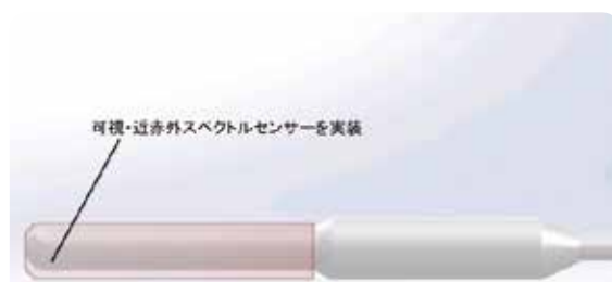
子宮内膜症の悪性化を診断するための経腔プローブ
