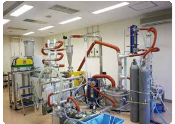
粉体用閉回路型低酸素気流連続式殺菌装置実用機レベル
