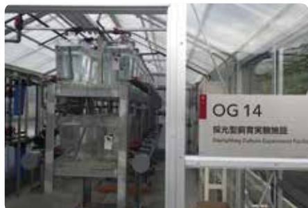
採光式自動給餌型の幼生・稚体飼育システム
