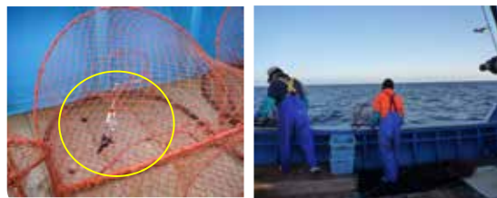
カニ籠に取り付けられたリモート水温計
