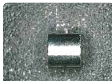
SBF溶液浸漬実験用試験片（2mmφ×2mmH）
