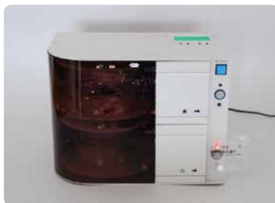
動作後の服薬支援装置 （薬包一包下部取り出し口より排出されたところ）
