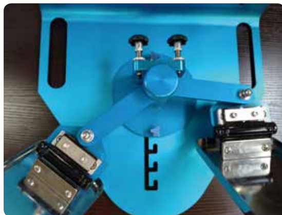
アーム後方にダンパー設置により騒音を軽減
