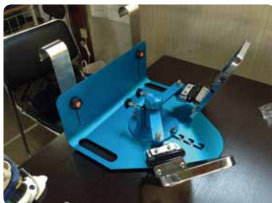
アルミ材によるボディの軽量化 総重量4.08kg
