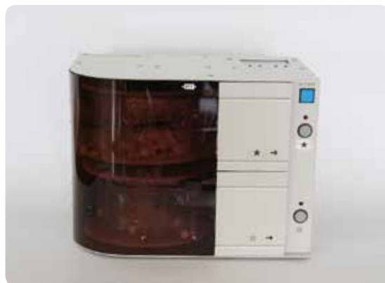
服薬支援装置の外観 （内部に帯状の薬包がベルト状に収納されている）
