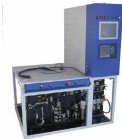
水素リークテストシステムの試作装置（チャンバ部無し）
