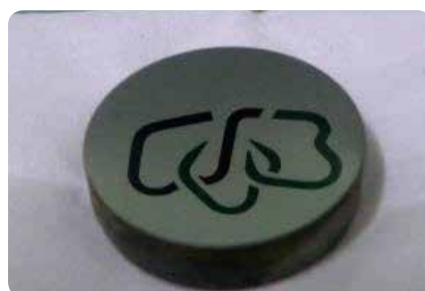
試験加工後のワーク表面（ボンド材評価試験）
