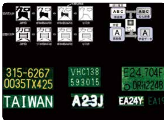
低品質文字の高精度認識法の開発 部分空間法を用いて文字を認識するアルゴリズムを実装し認識精度が改善しました
