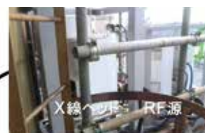
「現場非破壊診断の状況」 PCコンクリート道路橋・橋桁のX線非破壊診断実施(平成26年2月)
