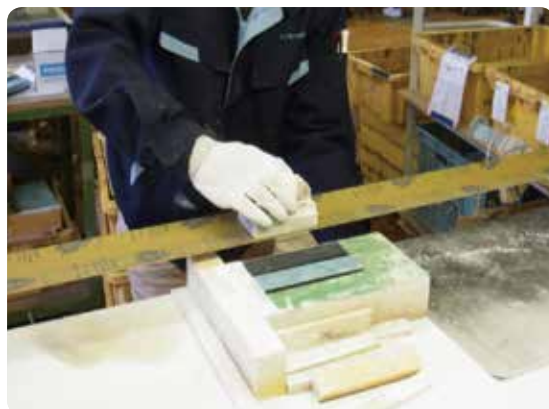
評価サンプルを製作している状況 ベルト研磨 従来の研磨作業時間 約30min
