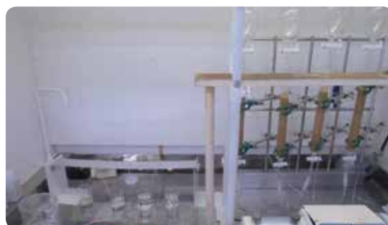
写真3 自動イオン交換システム
