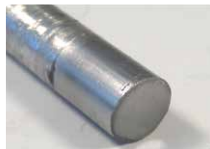
常温圧縮回転せん断法で試作したSPPA駆動体母材
