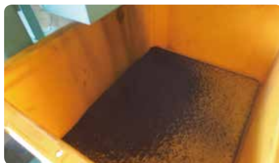
混練後の土壌粒子（混練後にロータリー磁選機にて分級する）
