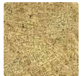
砂鉄鉄器铸铁組織
