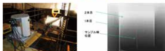
「現場非破壊診断の状況」 製品出荷用埠頭設備・コンクリート梁のX線非破壊診断実施(平成26年1月)
