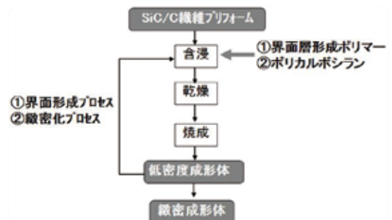
高靱性を得るためのPIP法による湿式法の界面層製造プロセス
