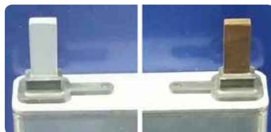
LiB部品の金属-樹脂接合部分（左：アルミ 右：銅電極部）
