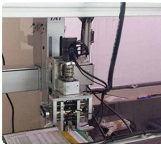
開閉機構と回転軸を有するLCR回路定数自動測定用測定プローブの試作ユニット外観写真
