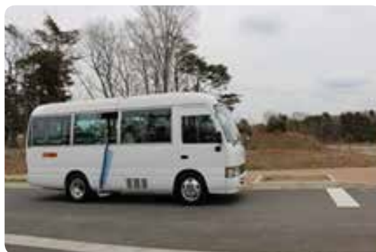
既存ディーゼル車にDDF化キットとCNGタンクを取り付けた天然ガスDDF車
