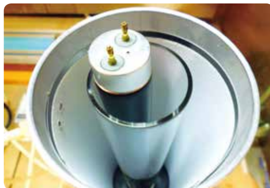
装置内部（平板状皮膜）の構造 （中心：紫外線ランプ、内管：石英ガラス）
