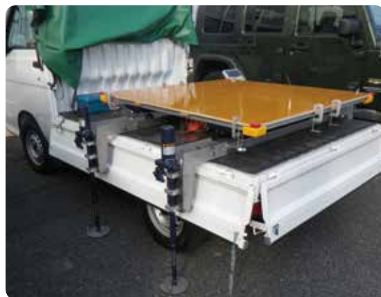
軽トラックに積載した可搬型放射性物質濃度測定器
