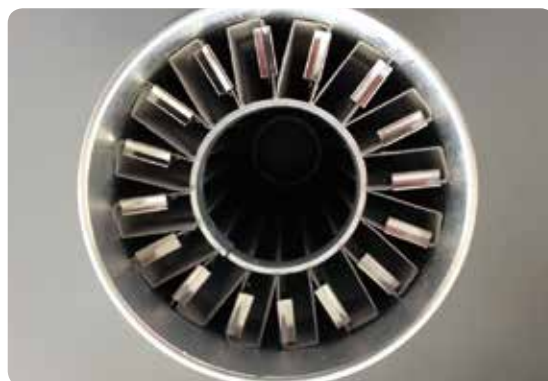
装置内部（折板状皮膜）の構造
