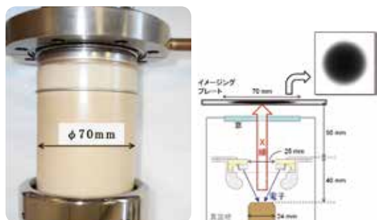
写真3 開発した冷陰極X線管とその構造図
