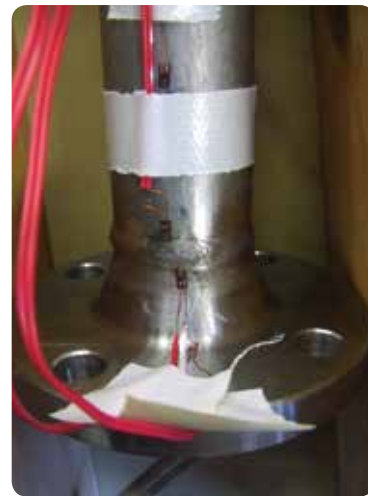
ひずみゲージを用いた溶接部の応力測定
