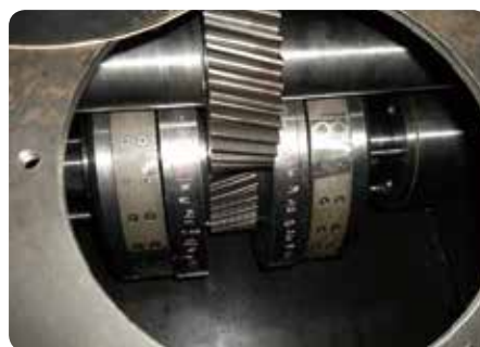
非接触式動力伝達装置（入力軸⇒下段 出力軸⇒上段）
