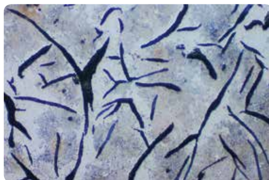
鋳鉄軸受に適したグラファイトの形状並びに組織（金型鋳造ではグラファイトのサイズが微細となり軸受材には適していなかった）
