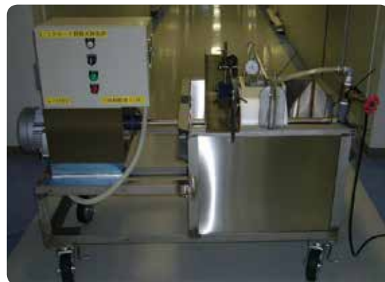
比磨耗量の試験装置。20年間の使用に耐える検証を行った。
