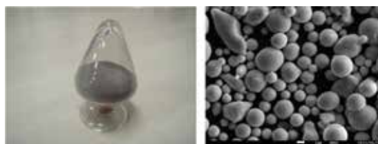
高速燃焼炎を用いたアトマイズプロセスにて製造した粉末試作サンプル（FeSiB系合金）
