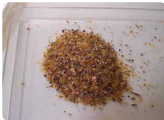
産出された“久慈琥珀”粉体（精製後） 開発した加熱プレス成形時の原材料
