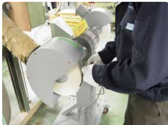
評価サンプルを製作している状況 パフ研磨 新規の研磨作業 約5min
