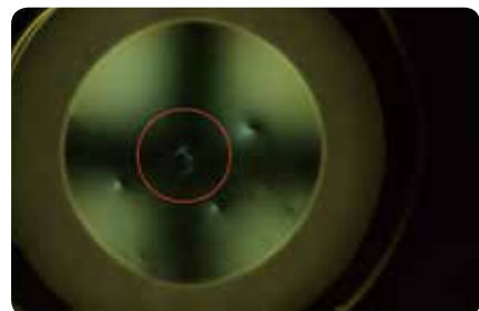
図3 欠陥観察の例（赤丸内に欠陥が見える）
