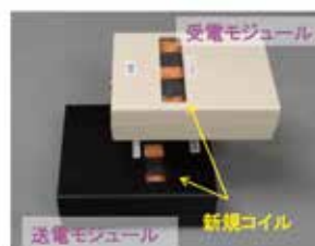
8字コイルを使用した電磁誘導方式
