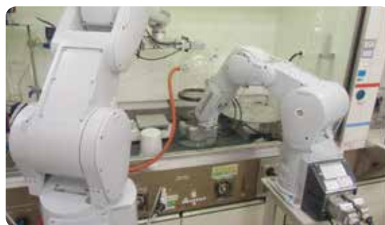
写真2 自動化学分離システム
