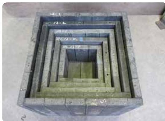
遮蔽板を5層の箱に加工した放射線遮蔽箱
