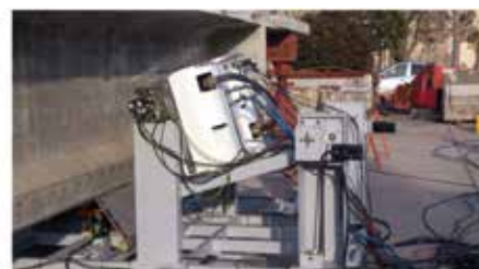
「現場非破壊診断の状況」 製品出荷用埠頭設備・コンクリート梁のX線非破壊診断実施(平成26年1月)
