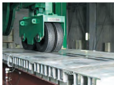
移動トラックタイヤ載荷疲労試験の様子
