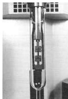
図1 試料フィルムと直接通電装置(TMAに接続)
