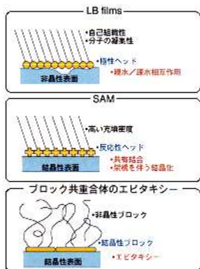
図1 有機薄膜の形成原理
