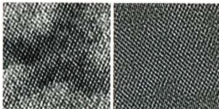
図2 傾斜照明をもちいたホログラフィによる分解能の向上
