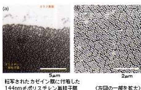
図2 ITOガラス表面のポリスチレン単粒子膜のSEM像
