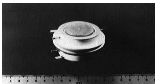
写真：両面ゲート SI サイリスタの外観写真 図 1：試作した両面ゲート SI サイリスタの断面概略構造
