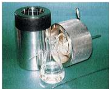
写真 2 超臨界二酸化炭素の水素化によるジメチルホルムアミドの合成 300ml の反応容器を用いて、薬さじ上の約 1mg の微量のルテニウム触媒により、二酸化炭素と水素とジメチルアミンからフランス内の約 60g の生成物が合成できる。
