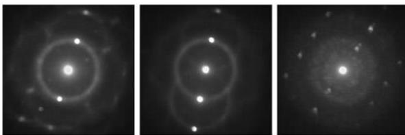
図 2 HR-TEM 観察で析出した結晶核から 2.4 nm 径のビームで得られたナノビーム電子線回折図形。
