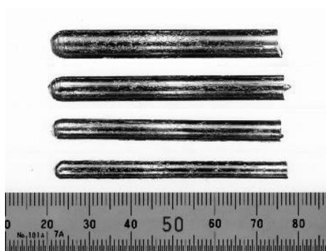
図 2 金型鑄造法により作製した  $Ca_{60}Mg_{20}Ag_{10}Cu_{10}$  金属ガラスバルク材の外観写真と熱的性質
