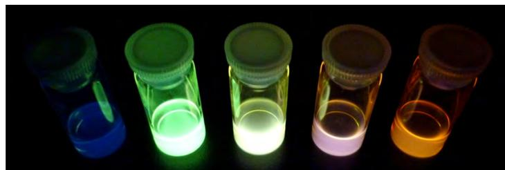
図2 トリフルオロメチルボラン錯体の構造（左）と錯体が様々な有機溶媒中で発光する様子（右）
