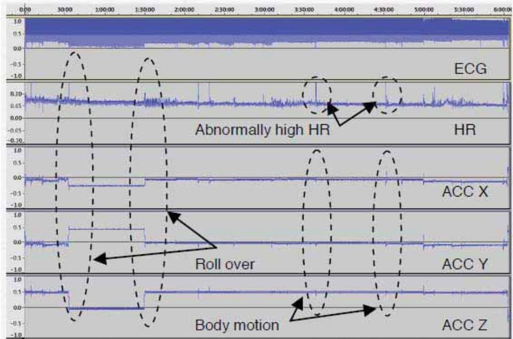
(d) ECG and 3-axis acceleration logging data at sleeping
