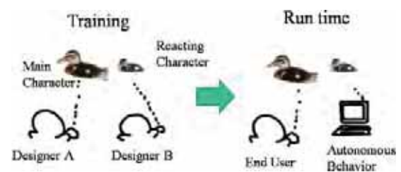
図 1: 主となるエージェント (Main Character) に対する、対となるエージェント (Reacting Character) の振るまいを例示によって作成する (Training phase). この結果を元に、Run time においてユーザが主となるエージェントを動かすことで対となるエージェントの振るまいが生成される。
