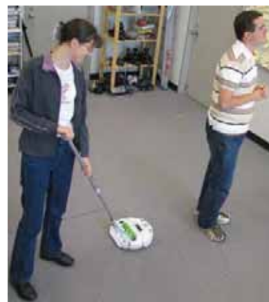
図 4: 直接ロボットを動かすシステムの概観。アルミニウムの棒を持ちいたロボットインタフェースで人を追いかける動作を作成しているところ。
