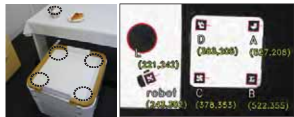
図 4. トラッキングシステムの外観 (左) と検出結果 (右)。点線内がマーカ。
