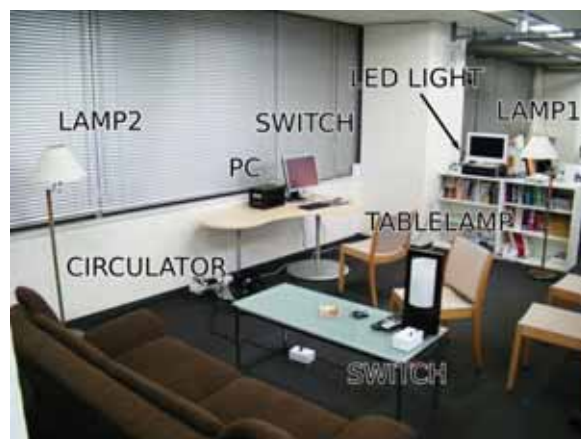
図 6 実験に用いた部屋および機器。被験者は照明などの機器をスイッチモジュールのスイッチに割り当ててを求められる。GUI を使う場合は、被験者は PC を操作して設定を変更する。
