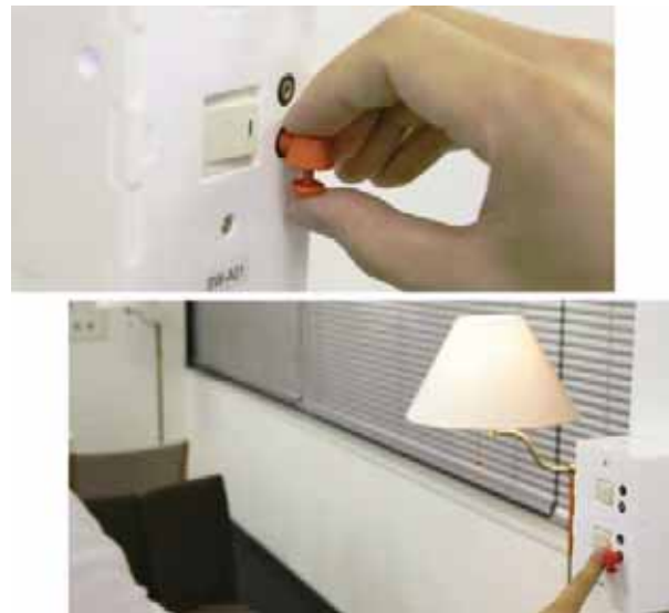
図 1 Push-pin プロトタイプ実装。フロアランプに対応するピンをスイッチに差し込むことにより、このスイッチでフロアランプの ON/OFF ができるようになる。
