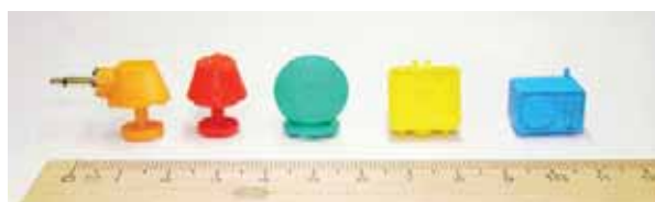
図 3 ピンのプロトタイプ実装。左より、フロアランプ (2 種)・扇風機・テレビ・オーディオプレイヤーに対応したものを。
