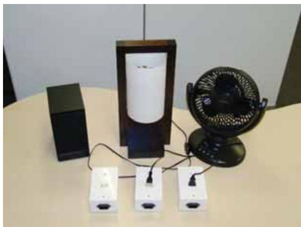
図 5 試作した出力モジュール。既存のランプや扇風機を、リレーにより ON/OFF する。
