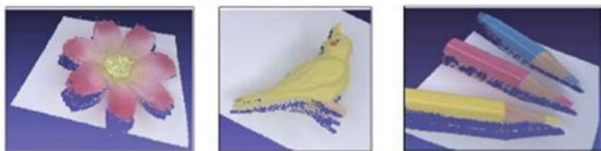
図 2.5 NIR-OLED を用いた 3 次元表面センシングによって得られた画像 48 。
