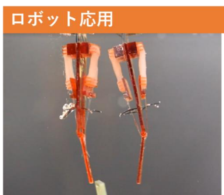
図 3-2 バイオハイブリッドロボット 48
