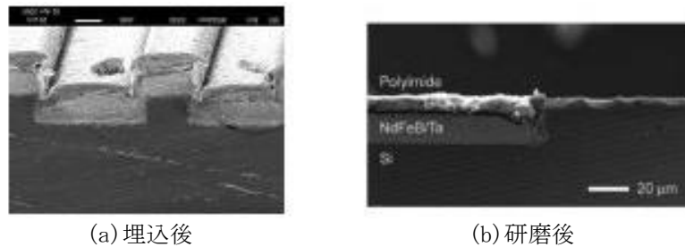
図 1-8 電磁誘導型の SEM 写真 13
