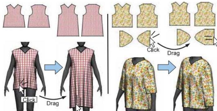
図 1-14A<sup>[13]</sup> 2次元衣服パターン(上)とそれに対応する3次元ドレープ(下)の両方を同時に同期してモデリングおよび編集するためのツールSCによって、時代を超越したこの問題は解決される。
