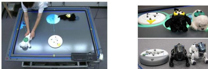
図 2-75<sup>[114]</sup> (左)おもちゃのインタフェースを使った遠隔ロボットグループとインタラクトしているユーザー；(右)有形で触れて感じることでできるインタフェースと、それに対応するロボット
