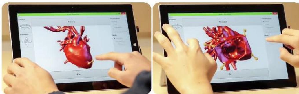
図 2-15<sup>[51]</sup> ブラウザーアプリケーションでユーザーは、マルチタッチインタラクションを通して心臓モデルを変形したりカットしたりすることができる。
