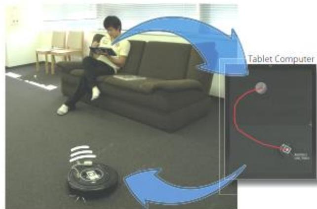
図 1-27<sup>[26]</sup> スケッチインタフェースを備えたホームロボットの制御:ユーザーがタブレット上でロボットの動きをスケッチすると、ロボットは部屋のスケッチされた動きに沿って進む。
