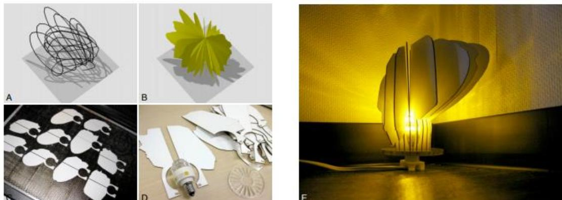
図 1-12<sup>[11]</sup> Spatial Sketch を使ったランプシェードの作成。(A)元の 3D スケッチ、(B)スケッチをラジアルにスライス、(C)レーザーカットしたカードのスライス、(D)組み立て前の最終パーツセット、(E)組み立てられたランプシェード
