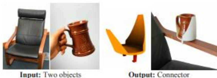
図 2-11<sup>[47]</sup> AutoConnect は2つの与えられたオブジェクトとユーザーの指定した形状をベースに 3D プリント可能なカスタマイズされたコネクターを作成する。作例は椅子にマグを取り付けるカスタムホルダー。
