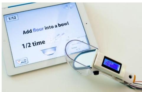
図 1-35<sup>27</sup> ロボット型計量スプーン「smoon」
