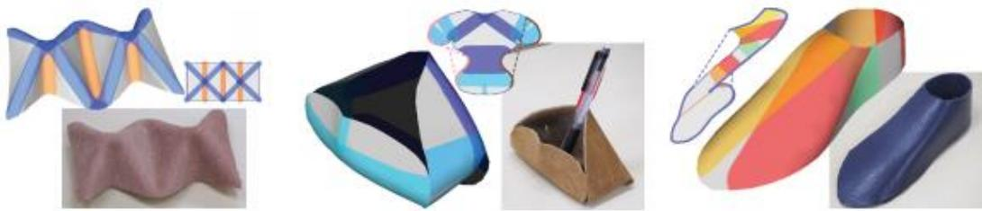
図 1-22<sup>[21]</sup> Soft Folding によってモデル化された薄板フォーム。左から右：革シート、革製のペンホルダー、靴に適用された Water-bomb 折り紙の模様。(サブ図形で対応する折り目と縫い模様を視覚化する。折り線の色と太さはその倍率とシャープネスを示す。継ぎ目は境界に太い曲線のペアとして表示される。)
