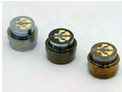
図 2 世界最小のダイヤフラム型圧力センサ
