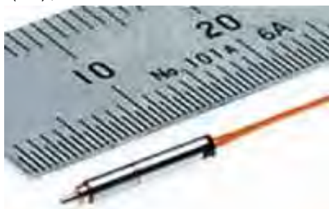
図 1 世界最小のマイクロギヤードモータ
