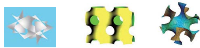
図 15. 三重周期極小曲面の例: 左から、シュワルツ D 曲面, シュワルツ P 曲面, ジャイロイド. ナノスケール物質の構造として現れる.
