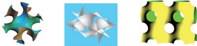
図 18. ジャイロイド(左),シュワルツD曲面(中),シュワルツP曲面(右)
