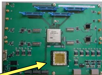
評価ボード上 ソケットへ実装
