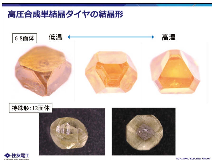
図4-2-3 高圧合成単結晶ダイヤの結晶形
