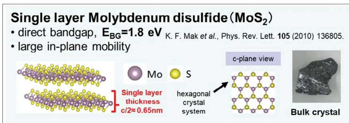
図3-4-1 MoS 2 結晶構造
