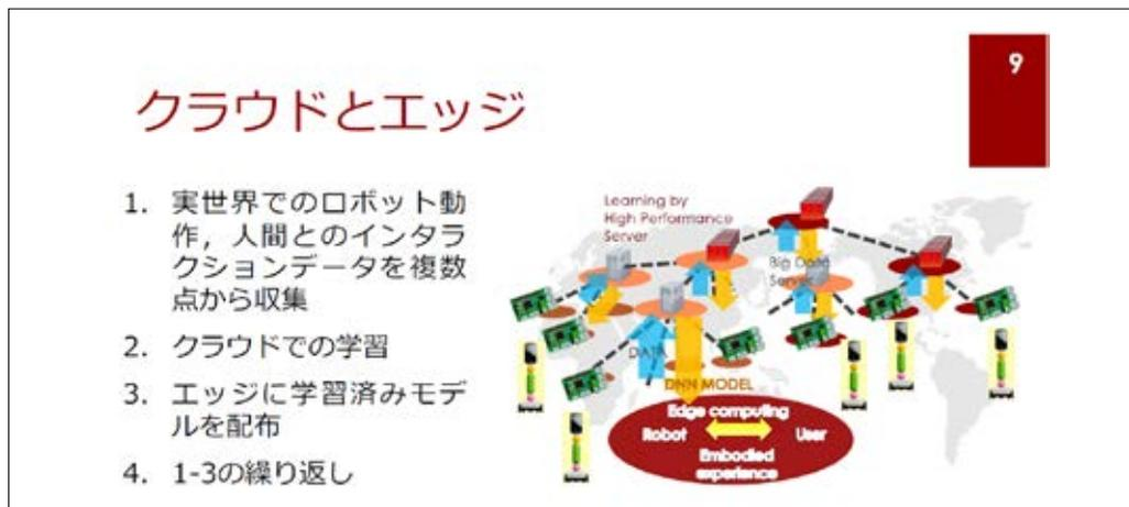
図2-3-2 エッジでのデータ収集とクラウドでの学習のイメージ
