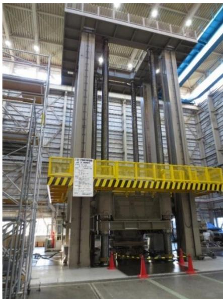
図 A1.4.1 30MN 大型構造物試験機（日本大学理工学研究所）<sup>39</sup>
