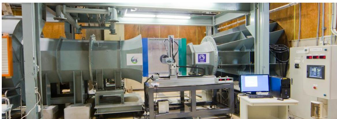
図 A1.4.2 低乱熱伝達風洞（東北大学流体科学研究所）<sup>40</sup>
