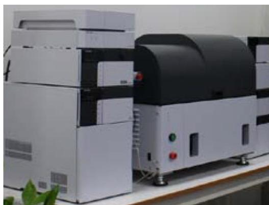
図 A1.5.5 流動場分離法（Field Flow Fractionation : FFF）を用いたナノ材料分析装置<sup>49</sup>
